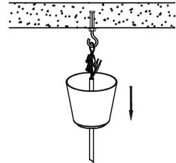
3. 将音频线连接好，把线罩杯推至紧贴天花板，罩住挂钩与音频连接处。
